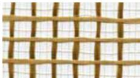
5.6-сурет – Тас қабырғалардың беттерін арматуралауға арналған композициялық материалдардан жасалған Ruredil XMech 10 (а) және Ruregold Muratura XR (б) арматуралық торлары [37]
