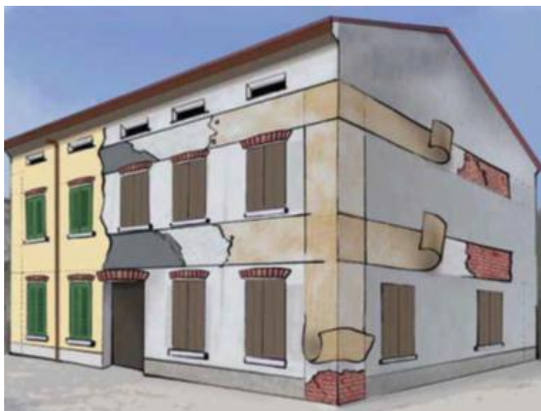
Рисунок Д.6 – Армирование сетками из композитных материалов стен каменного здания, подверженного сейсмическим воздействиям [37]
