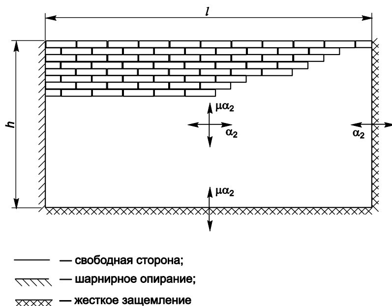
Рисунок 6.7 – расчетная схема горизонтально нагруженной стены ( \alpha_2, \mu\alpha_2 – коэффициенты изгибающего момента в указанных направлениях) [СН РК EN 1996-1-1:2005/2011]
