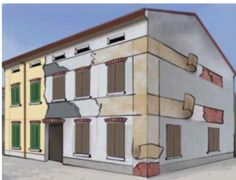
Д.6-сурет – Сейсмикалық әсерлерге ұшыратылған тас ғимарат қабырғаларын композиттік материалдардан жасалған торлармен арматуралау [37]
